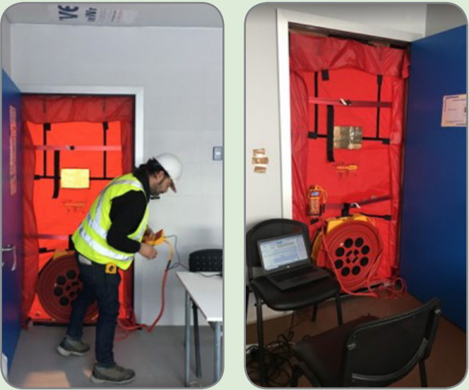
HERMETICIDAD DE LA ENVOLVENTE: Se realizo test de infiltración por la envolvente
